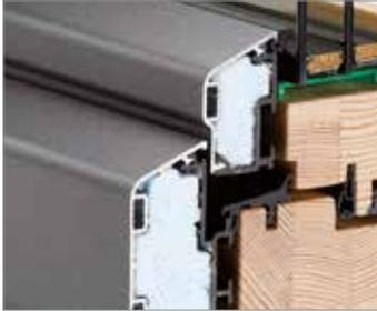
Die PU-Dämmung in der Aluminiumschale optimiert die Wärmedämmung im Bereich des Rahmens und des Flügels.
