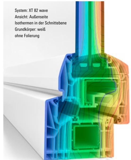
Parameter der dargestellten Isothermen:  $T_a = -5^\circ\text{C}$ ,  $T_i$  bei  $20^\circ\text{C}$  und 50 % relative Luftfeuchte, Linie rot:  $13^\circ\text{C}$ , Linie blau:  $10^\circ\text{C}$ , Linie Schwarz:  $0^\circ\text{C}$ .
